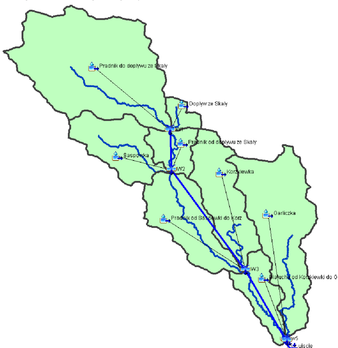
Rys.19 Jednostki zadaniowe w zlewni Prądnika i Garliczki – schemat modelu HechMS
