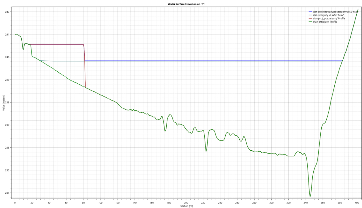
Rysunek 18. Rozkład poziomy wody p1% w przekroju P1. Stan PZRP vs Wariant 1.
