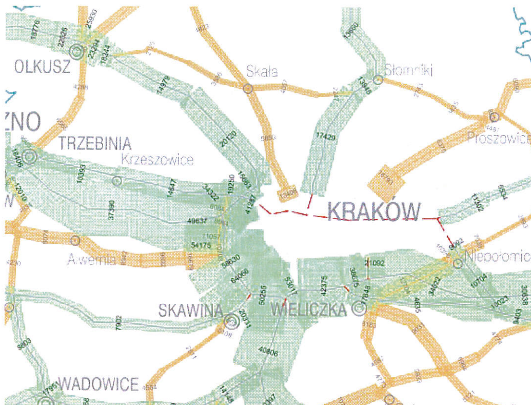
Rycina 2. Średni dobowy ruch pojazdów silnikowych na drodze wojewódzkiej nr 794 oraz drodze krajowej nr 7
