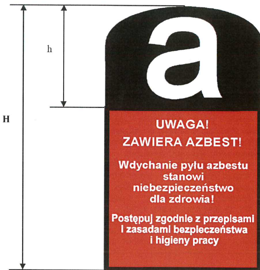
Rysunek 6. Wzór oznakowania wyrobów, odpadów i opakowań zawierających azbest lub wyroby zawierające azbest, a także miejsca ich występowania.
